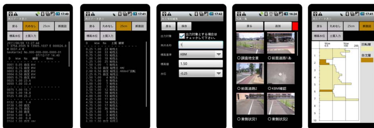
G-Web mobile：地盤調査機から出力される生データをスマートフォンの画面に表示し、現場ですぐにデータを確認することができます
