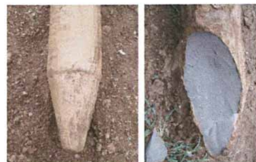
掘り起こしたピュアパイルとその断面(写真右)土がまったく混入されていないのがわかります。
