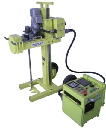
(写真：SDS 試験機)
