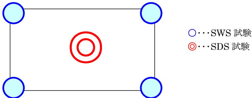
◆SDS 試験を行なう場合、通常 SDS 試験を建物中心 1 ポイント、SWS 試験を建物 4 隅 4 ポイントにて行います。
