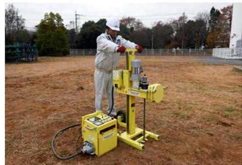
SDS 試験による地盤調査風景
