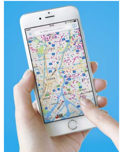
<地耐力（地盤の強さ）表示画面> 地耐力に応じて、画面上のドットが色分けされています
